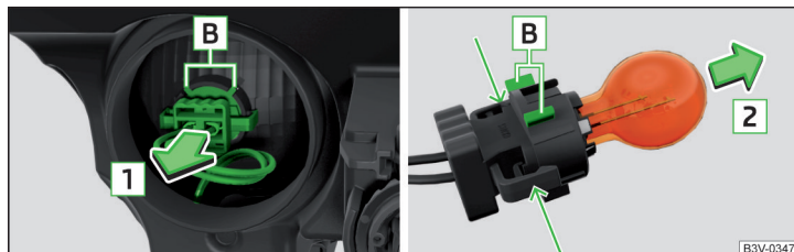
Obr. 357 Výměna žárovky předního směrového světla
