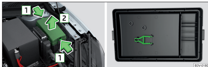
Obr. 354 Kryt pojistek: vyjmutí krytu / plastová svorka na pojistky
