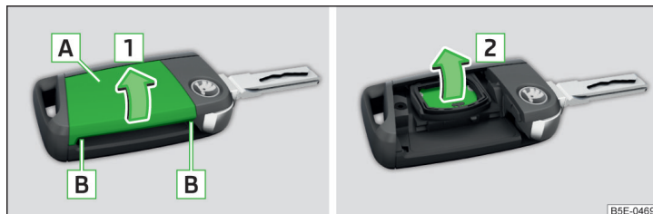
Obr. 336 Odklopení krytu / Vyjmutí baterie
