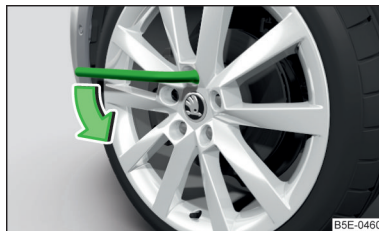
Obr. 328 Povolení šroubů kola
