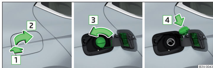
Obr. 308 Odklonění krytu hrdla palivové nádrže / Vyšroubování uzávěru / Nasazení uzávěru na kryt
