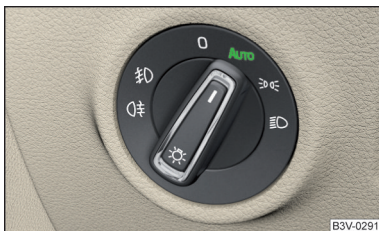
Obr. 62 Spínač světel: poloha AUTO
