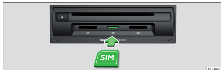
Obr. 202 Zasunutí SIM karty do externího modulu
