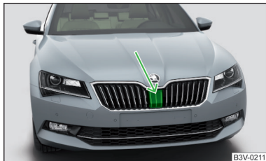
Obr. 262 Umístění radarového snímače
