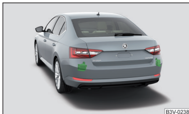
Obr. 269 Umístění radarových snímačů
