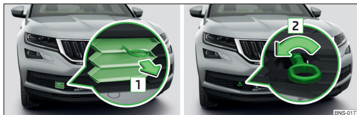
Obr. 346 Vyjmutí mřížky / Montáž vlečného oka
