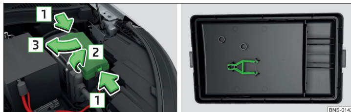
Obr. 365 Kryt pojistek: vyjmutí krytu / plastová svorka na pojistky
