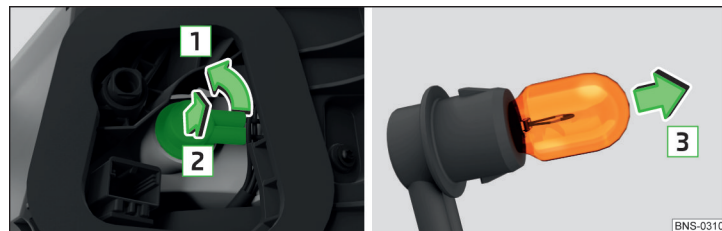
Obr. 376 Výměna žárovky / Montáž svítliny
