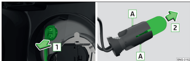
Obr. 369 Výměna žárovky obrysového světla
