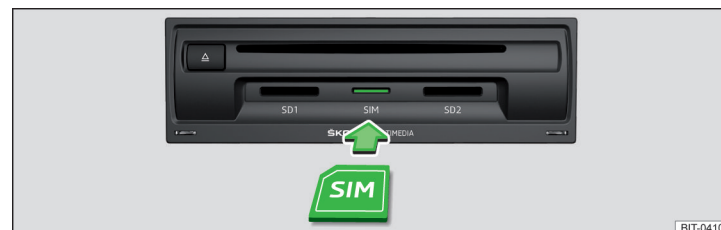
Obr. 202 Zasunutí SIM karty do externího modulu
