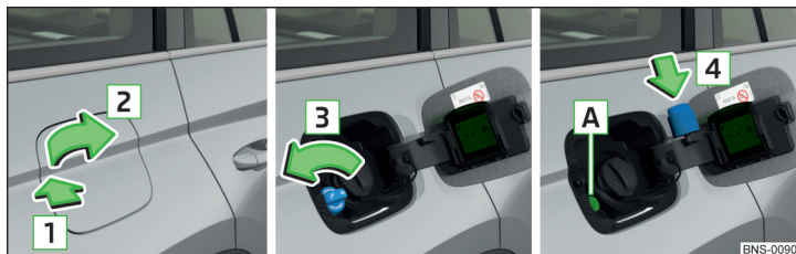
Obr. 322 Odklopení krytu hrdla palivové nádrže / Vyšroubování uzávěru / Nasazení uzávěru na kryt
