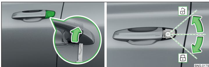
Obr. 353 Klikla dveří řidiče: odklopení krytu zámku / odemknutí a zamknutí
