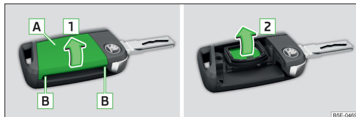
Obr. 348 Odklopení krytu / Vyjmutí baterie
