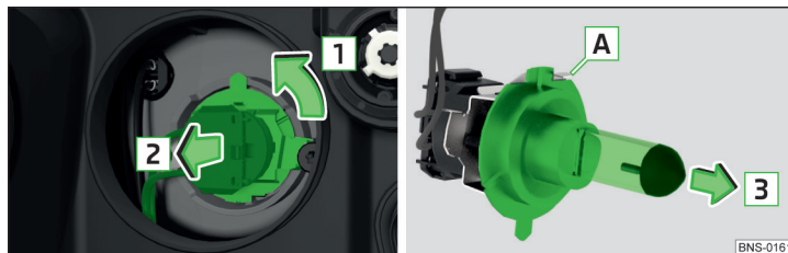
Obr. 368 Výměna žárovky dálkového světla
