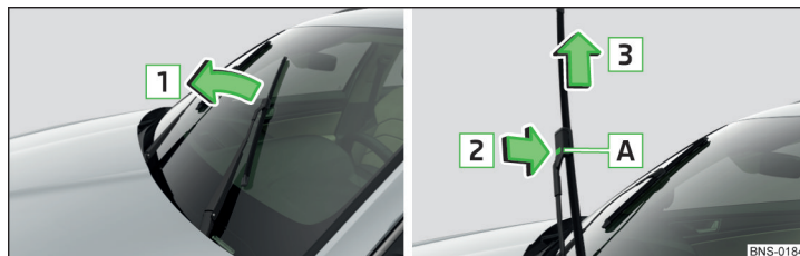
Obr. 359 Výměna stírací lišty čelního skla
